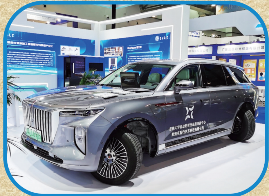
长春市麦迪克智行汽车科技有限公司，与长春市科技局、长春新区签订承接吉林大学自动轮行底盘成果转化项目，得到长春市种子基金首笔投资500万元。图为D01型号（红旗Eh9s）自动轮行底盘技术实验车平台。
